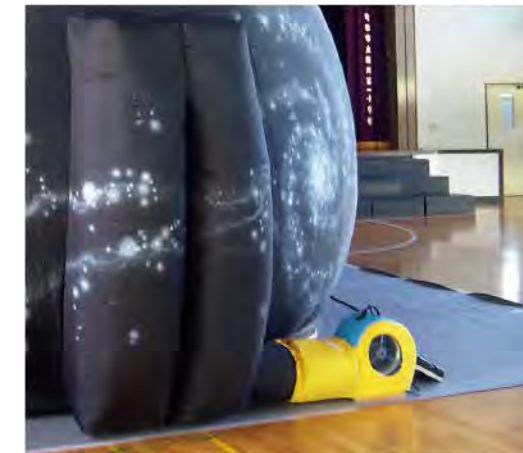
エアードームはふくらみを維持するため、常に外気を取り入れえています。
